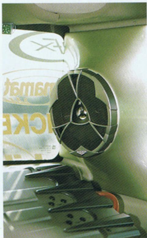
フロント、センター、そしてリアと、各スピーカーはキッカー・KX650.4×2基を利用してマルチドライブ。ちなみに成形されたバッフル回りはカーゴスペースと同色化。
