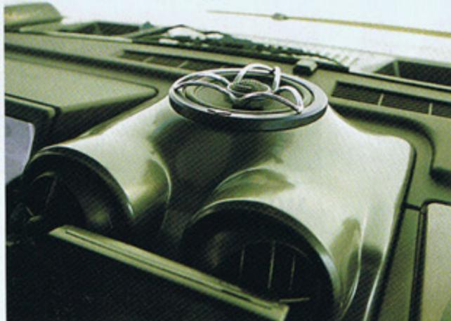
センタースピーカーもフロント同様のキッカー・SSシリーズを選択。5.1チャンネルシステムで、セリフなどの再生を担当する重要な役割を果たしているだけにハイエンドモデルの採用も納得だね。
