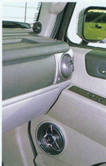
ステレオ再生での要となるフロントスピーカーには、パワー感やスピード感をはじめ高音質を実現するためキッカーのハイエンドモデルであるSSシリーズ・SS65.2を採用。ミッドレンジのプロテクションデザインもおしゃれな逸品。
