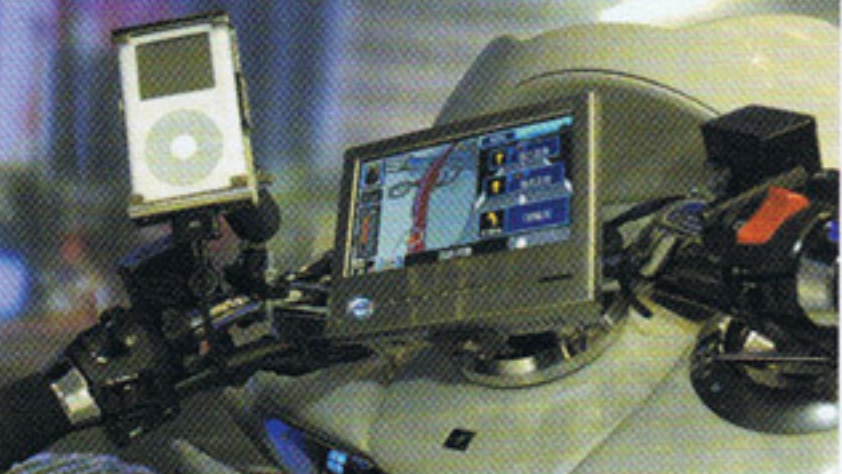
ハンドルポストにはナビゲーション、ハンドルにはiPodが搭載されている。どちらのステーもワンオフで制作している。フロントボックス内にはアルパイン製1 DINユニットを収納。
