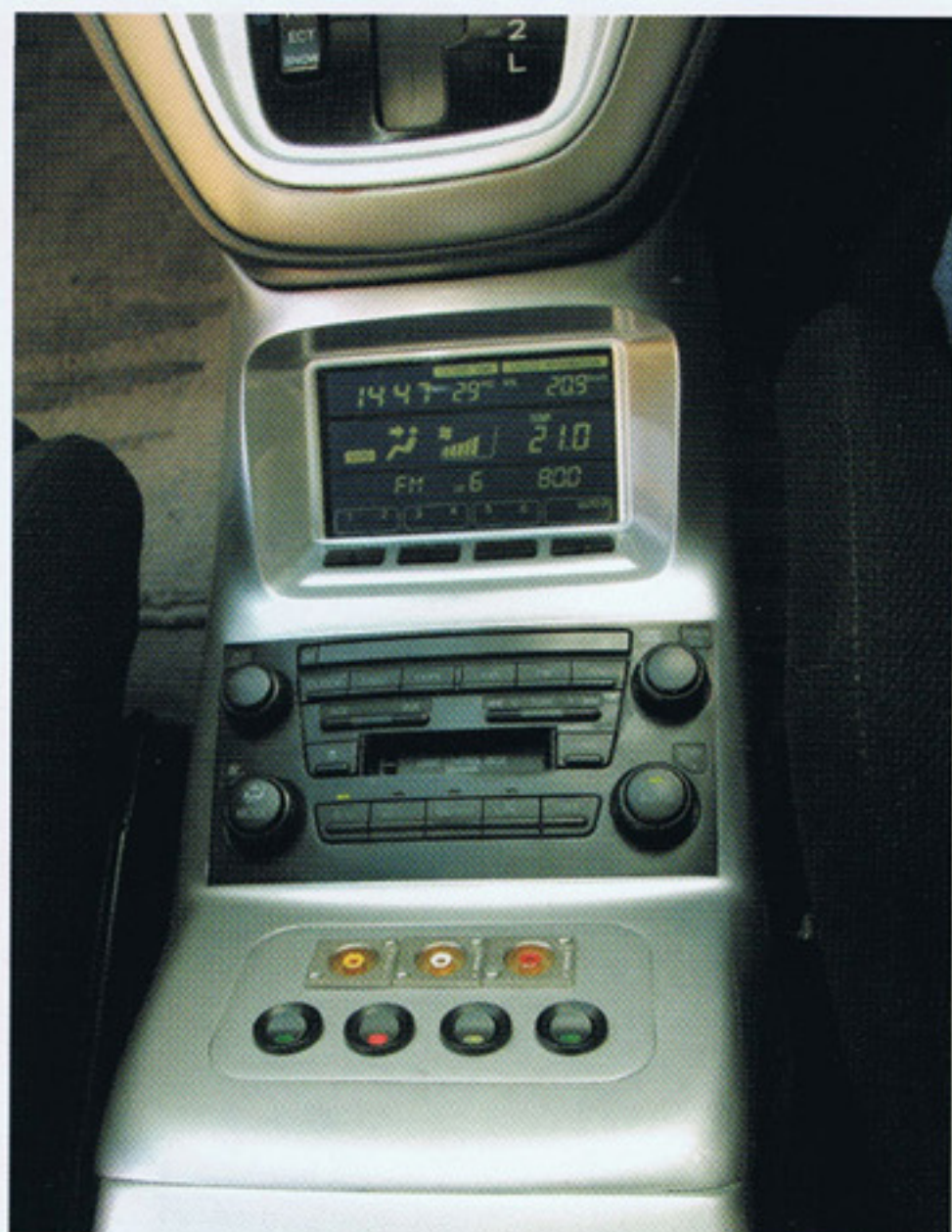
ここが自慢のカスタムセンターコンソール。純正のオーディオ&エアコン操作パネルが移設されている。デジタルビデオで撮った映像もそのまま流せるようにジャックも搭載しているのだ。
