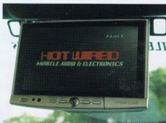
ルームミラー部分に取り付けられた8インチのワイドモニターは上下左右に自在にスイングするというスグレものだ。
